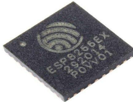
Fig 1.1: ESP8266 SoC IC [2]
